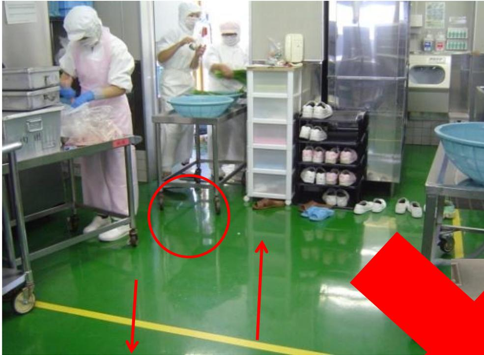
汚染区域、非汚染区域は線引きで区分しているが、台車、人の行き来が多いので、汚染作業、非汚染作業が交差している。
